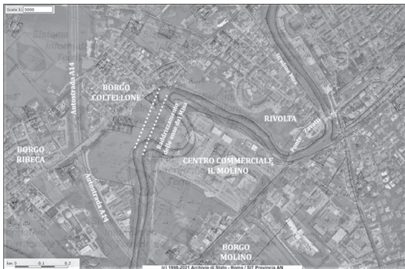
13. Raddrizzamento di due meandri del Misa nella zona ex Spedaletto di Senigallia. In base alle carte IGM la modifica è avvenuta post alluvione 1897 e ante anno 1907 (Cartografia storica del Sistema Informativo Territoriale della Provincia di Ancona; sovrimpressioni grafiche dell'autore di questo saggio).
